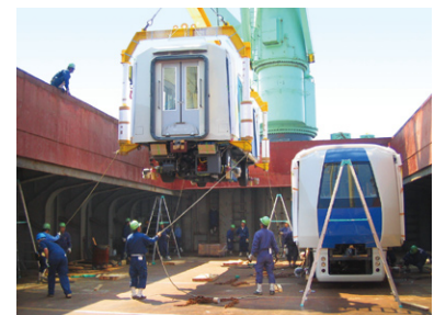
香港向け地下鉄車両の積み込み状況
