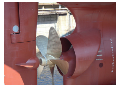
「SHIN-EI」「SHINWA-MARU」に取り付けられた省エネ装置 提供:ユニバーサル造船(株)
