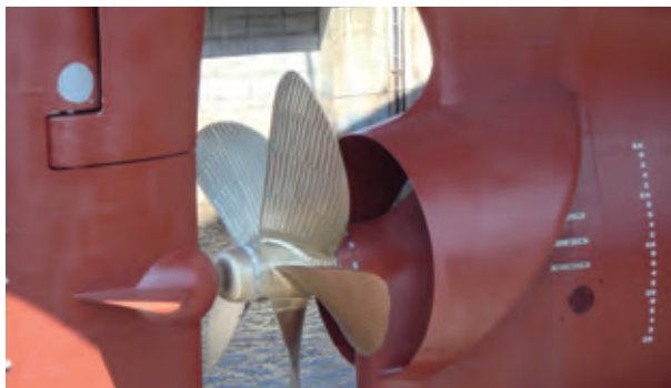
▲ [SHIN-EI]、[SHINWA-MARU] プロペラ前方に取り付けられた筒状の水流整流装置 提供:ユニバーサル造船(株)
