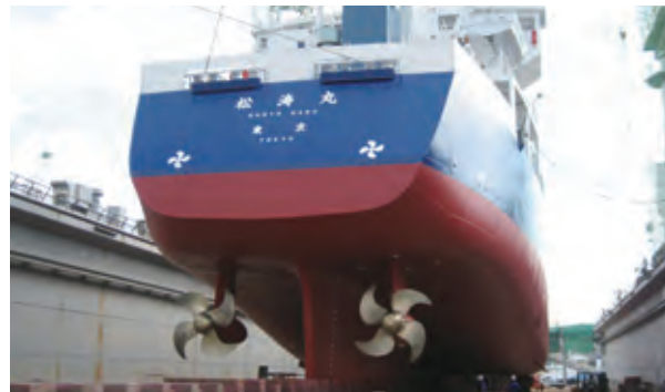
▲ 松涛丸 CPP式推進ポッドプロペラ
