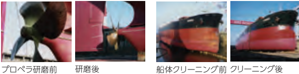
プロペラ研磨前 研磨後 船体クリーニング前 クリーニング後
