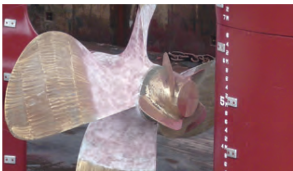
▲ [NSS DYNAMIC]入渠工事にてプロペラ後部に取り付けられた水流整流装置
