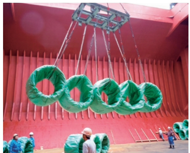
ワイヤーロッドの積み付け
