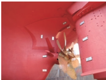
下北丸に取り付けられた省エネ装置
