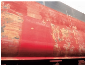
君鉄丸「省燃費型船底防汚塗料」塗装
