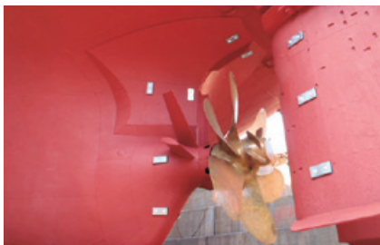
下北丸に取り付けられた省エネ装置
