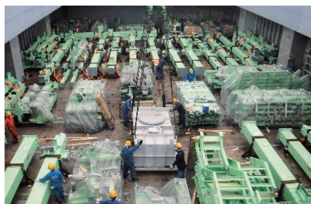
Structure積荷役（貨物形状や保定スペースを考慮した積み付け）
