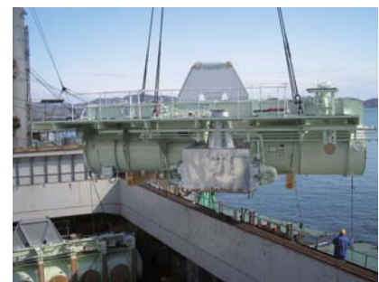
船舶用エンジンの積み込み状況
