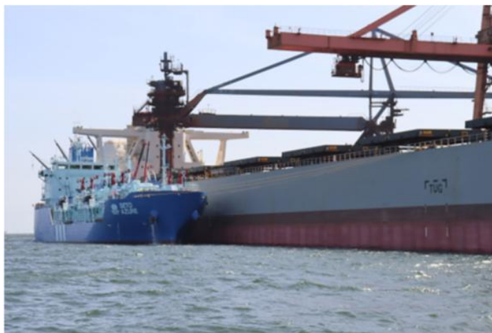
「SETO AZURE」(左)による STS 方式での LNG 燃料供給
